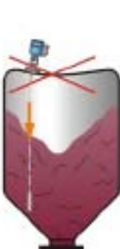
4mm缆用于量程小于10米，拉力小于1吨； 8mm缆用于量程小于35米，拉力小于3.5吨
