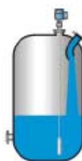
进料口采用弯管的形式，以免进料直接接触探杆
