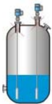
安装短管的直径大于安装短管的高度
