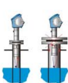
喇叭口与短管壁间隙 <2.5\text{mm}
