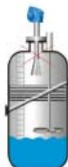
避免罐内物体接触雷达波束
