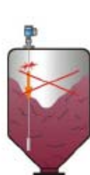
4mm缆用于量程小于10米，拉力小于1吨； 8mm缆用于量程小于35米，拉力小于3.5吨
