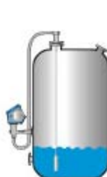
测量和显示部分分体安装
