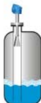
内浮筒（静井）形式安装，防止泡沫
