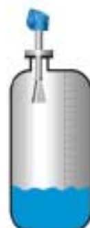
避免罐内物体接触雷达波束
