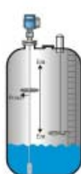
对于单杆缆, R > 300\text{mm} 对于双杆缆, R > 100\text{mm} 对于同轴没有距离要求
