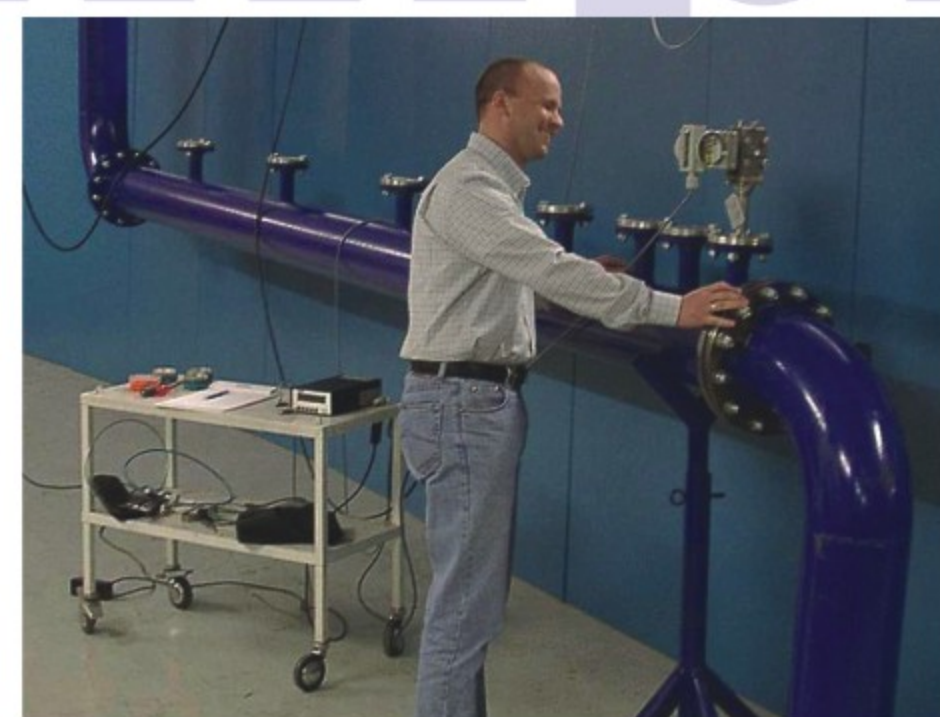
进行不同直管段下的探头精度试验
