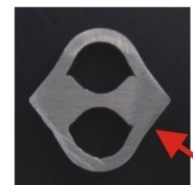
焊缝在非关键转弯处，无任何尺寸变化
